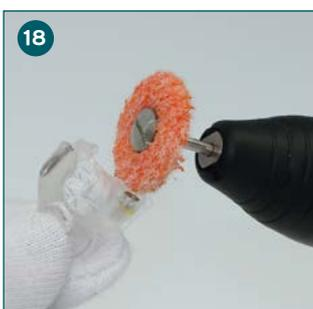
Schnittländer der Schiene mit der DIMO®PRO SLIM (REF 3376) mit max. 10.000 U/min abrunden.
